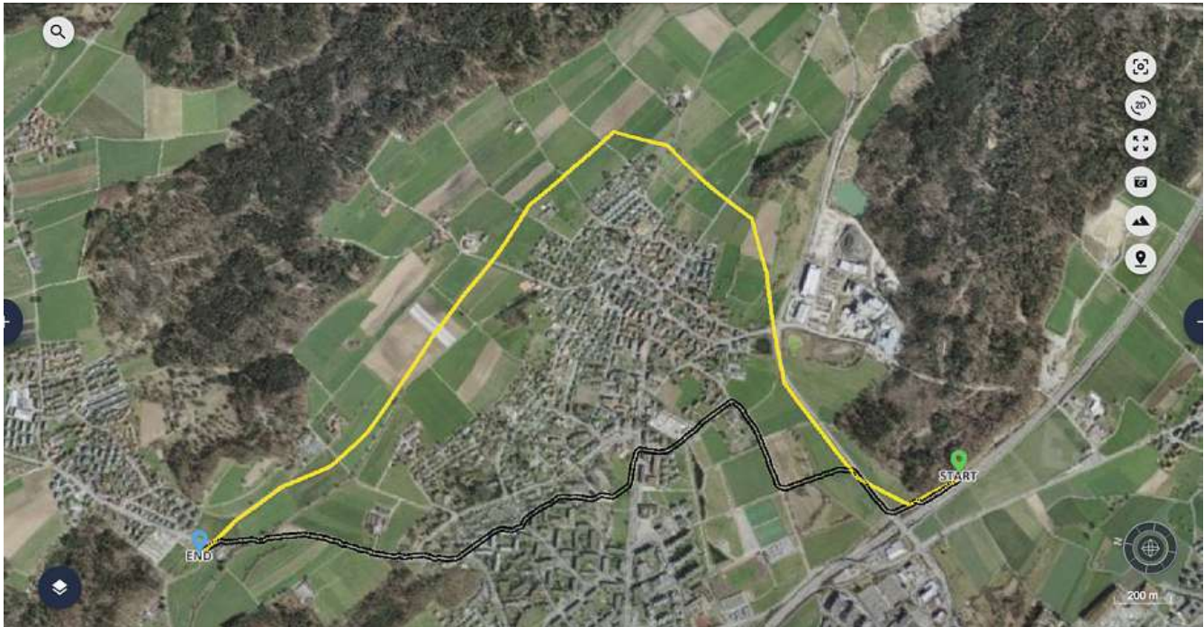
Vergleich zweier 110-kV-Leitungen (gelb = Freileitung; schwarz = Erdkabel).
