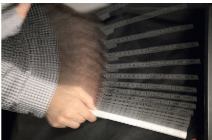
Bild 4 Stroboskop-Effekt: Ein bewegtes Objekt unter einer zeitlich schnell veränderlichen Beleuchtung.
