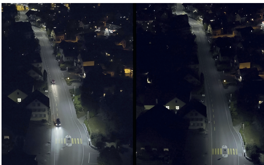
Birmensdorferstrasse in Urdorf – links mit 100% Lichtstärke, rechts mit reduzierter Lichtstärke (40%).
