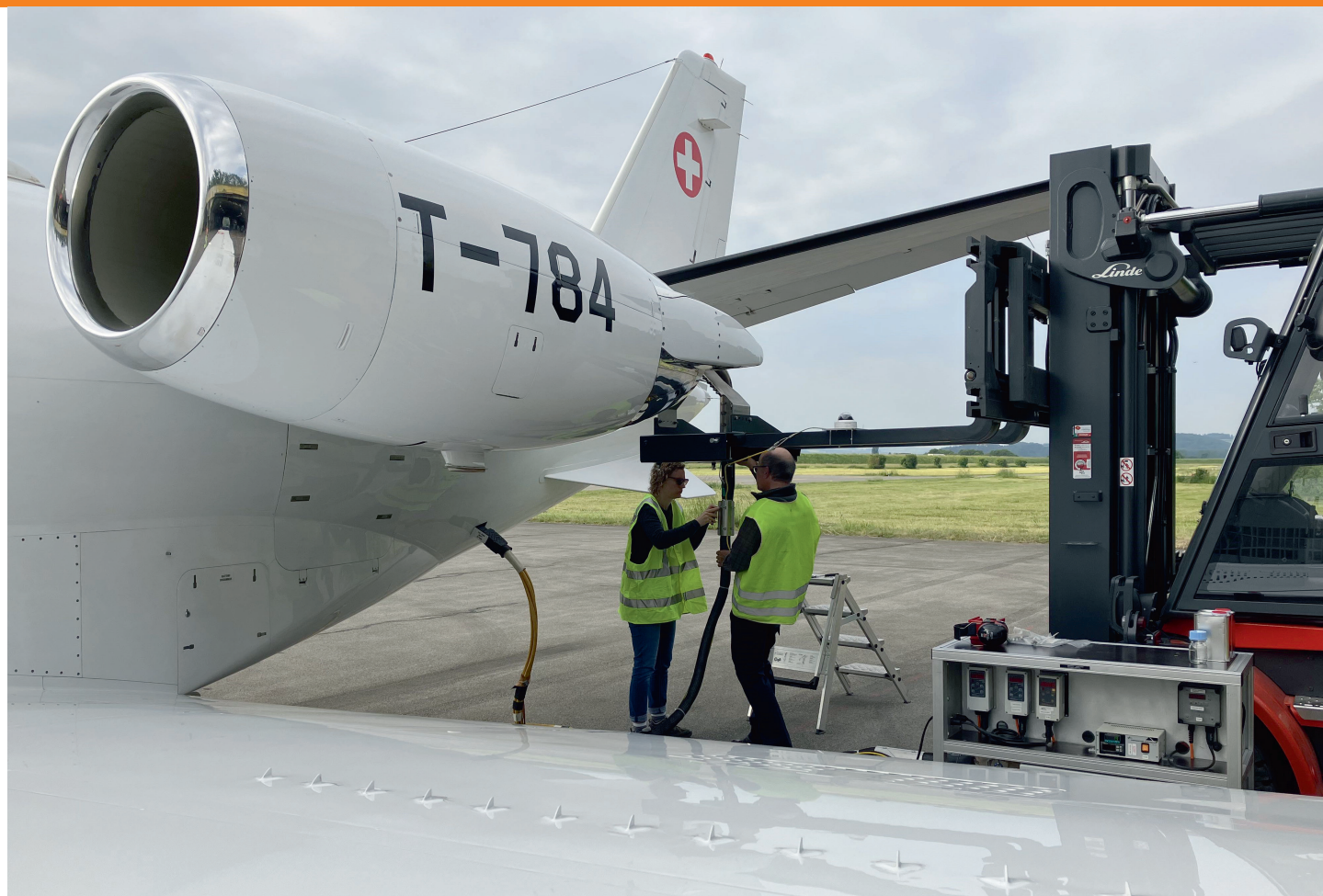
Abgasmessungen bei Verwendung eines nachhaltigen Flugtreibstoffs in Payerne, Mai 2023.
