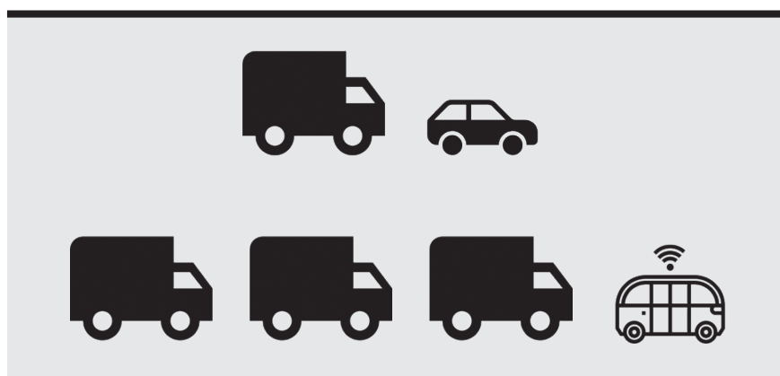
Figure 3 Illustration du « platooning » ou déplacement de camions en peloton.
