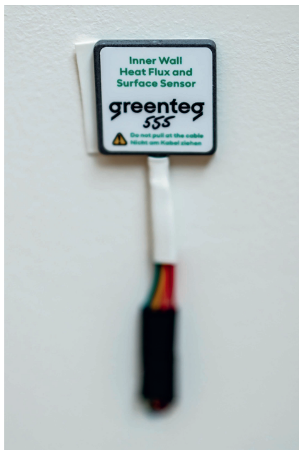
Bild 3 Im Forschungsmodul sind sechzig 30 x 30 x 3 mm grosse Wärmefluss-sensoren auf alle Raumflächen verteilt installiert.
